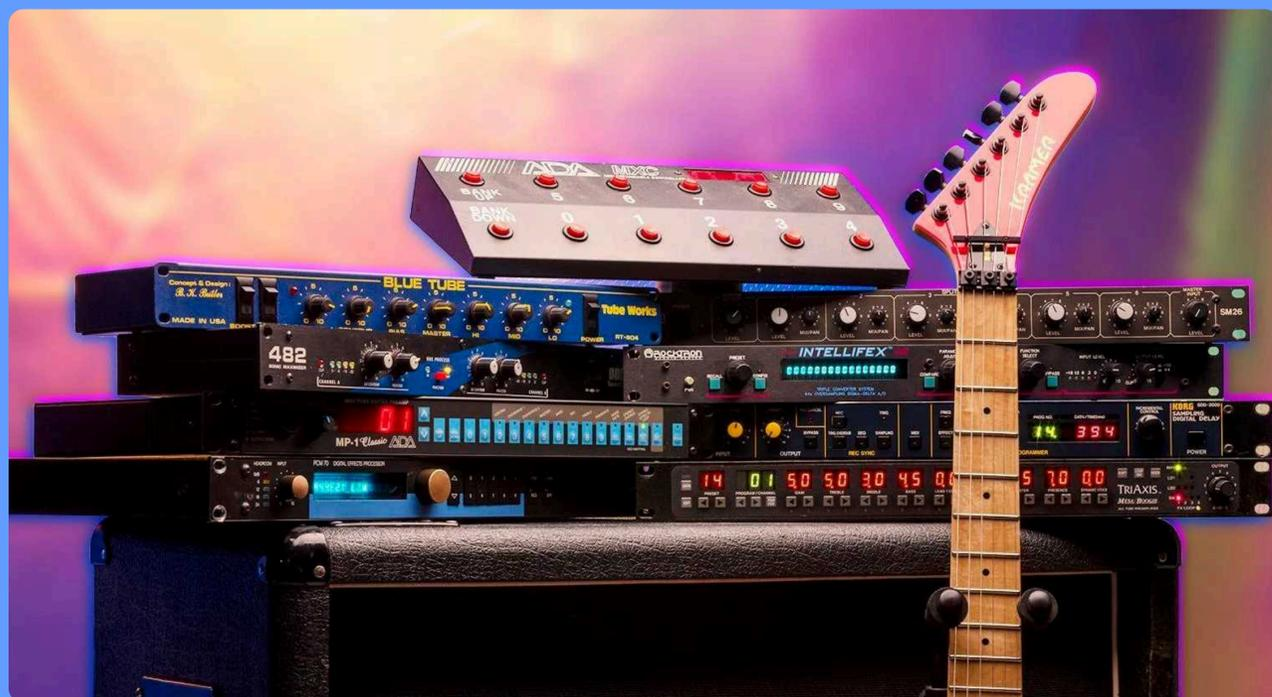
Знакомьтесь, гитарный рэк. Это специальный блок или стойка, в которую устанавливаются различные устройства для обработки звука гитары. Вместо того чтобы просто подключать гитару к усилителю, гитарист может использовать рэк, чтобы включить в цепочку звучания разные эффекты и обработки.
